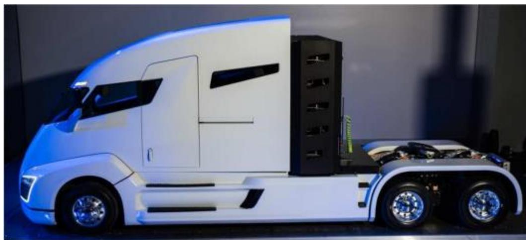
**Hình 2.13. Xe điện Nicola one đạt công suất 1470kW, pin Lithium – ion 320kWh**
