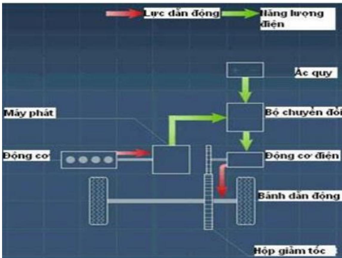
**Hình 2.31. Sơ đồ nguyên lý ô tô lai nối tiếp**
