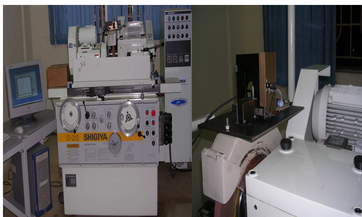
Hình 4. Ảnh thiết bị đo trên máy mài tròn
