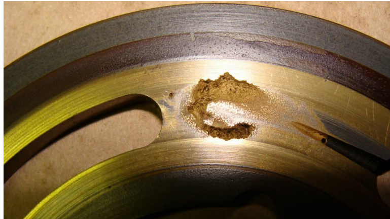
Hình 1.2. Đĩa phân phối của bơm pittong bị bong tróc do xâm thực
