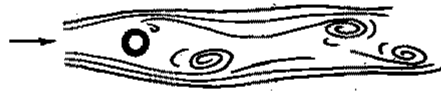
Hình 5.8. Đường xoáy Bernair-Carman ở mặt khuất gió khi dòng gió song song chảy vòng qua ống hình trụ
