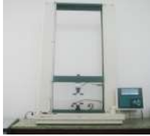
Hình 3.15. Thiết bị đo độ bền kéo (Hounfield)
