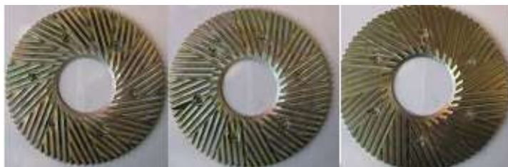
Hình 3.6. Đĩa nghiền bột giấy dùng trong thực nghiệm
