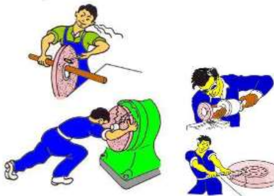
Hình 3-11. Đảm bảo an toàn khi gia công trên máy mài
