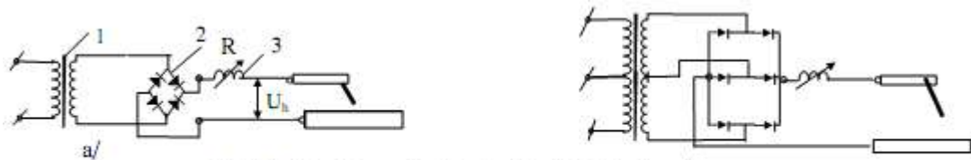
H.5.7. a/ Sơ đồ nguyên lý máy hàn chỉnh lưu ba pha b/ Sơ đồ nguyên lý máy hàn chỉnh lưu một pha
