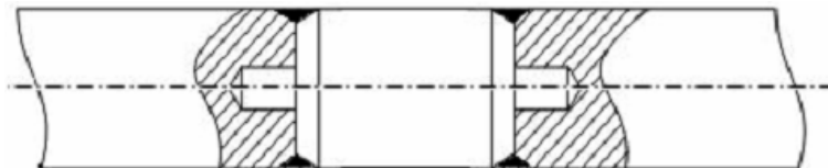
Hình 3.6. Phục hồi trục gãy có đoạn nối thêm
