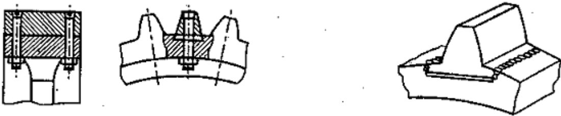
Hình 3.17. Ghép răng mới bằng bulông và bằng hàn
