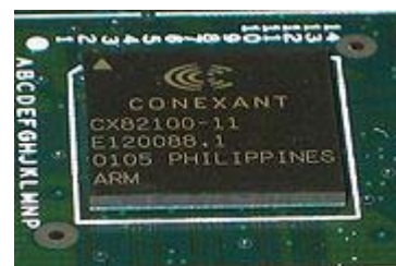
Một bộ vi xử lý Conexant được dùng chủ yếu trong các bộ định tuyến
